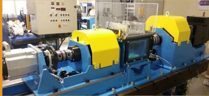
Banc d'essai synchro boîte de vitesse (BTSFC2)
