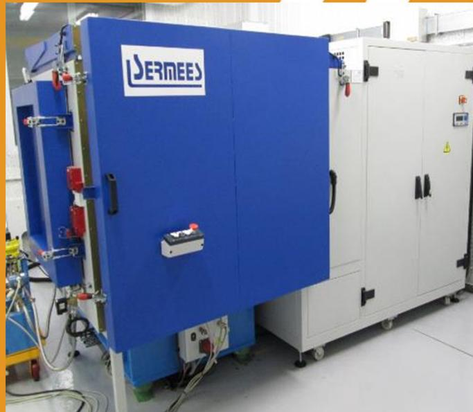
Banc d'essai de rendement de boîte de vitesse sous chambre climatique (BCFCC)
